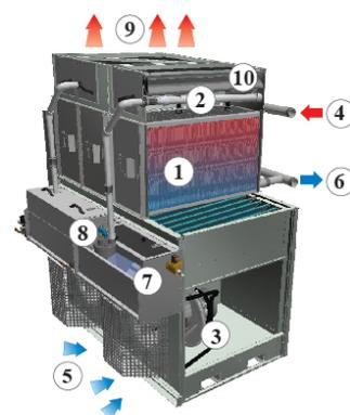
Wenn ein Modul **trocknen** arbeitet, wird die Sprühpumpe abgeschaltet. Wärme wird dann mithilfe von sensibler Wärmeübertragung von der Prozessflüssigkeit zur Umgebungsluft übertragen.
