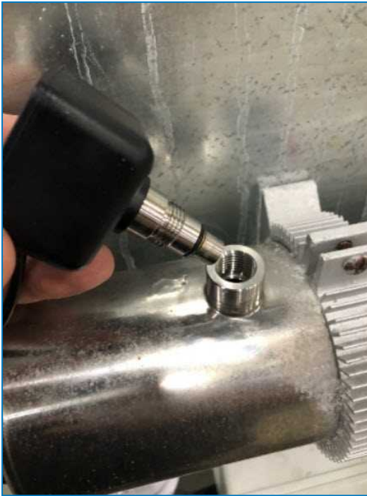
Снятие датчика интенсивности
