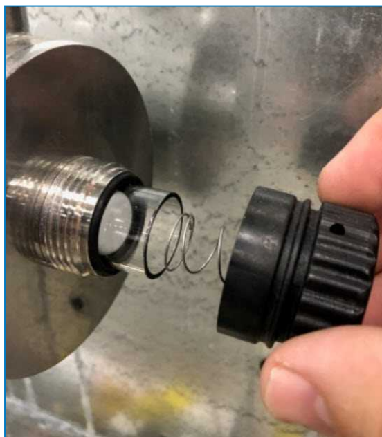
Снятие кварцевого рукава УФ-излучения
