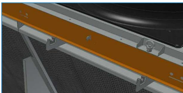
6. Installare le cerniere sul pannello superiore.
