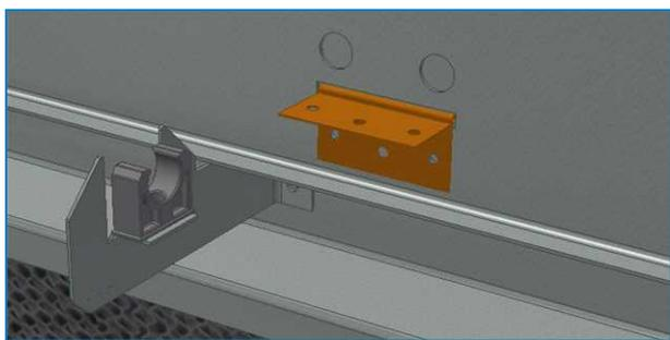
7. Installare il tubo di distribuzione acqua nelle fascette del tubo con i fori rivolti verso l'alto e il collegamento filettato di lato con il pannello elettrico. In caso di unità lunghe, è necessario unire più tubi utilizzando un manicotto di gomma.
