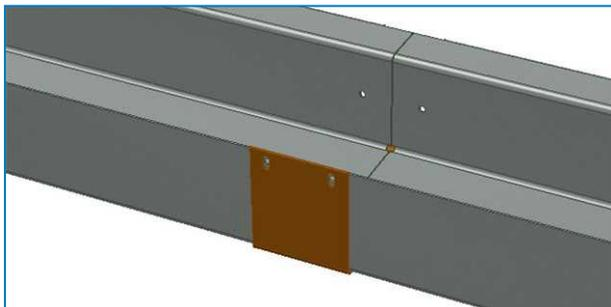
21. Installare la canalina di raccolta acqua inferiore sul telaio.
