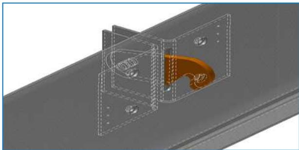
5. Installare il pannello superiore sui supporti del tubo.
