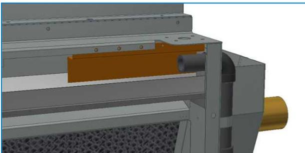
14. Installare l'ultimo coperchio anteriore e bloccarlo in posizione mediante viti nei fori adiacenti.
