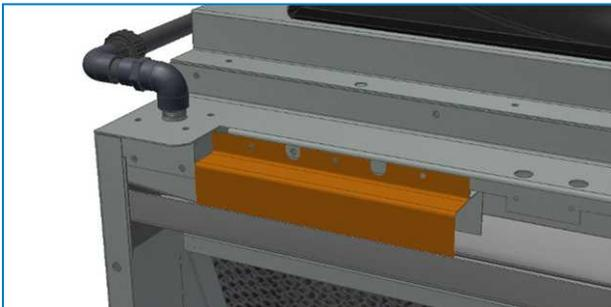
13. Installare il coperchio posteriore sull'altro lato e bloccarlo in posizione con una vite nel foro centrale.
