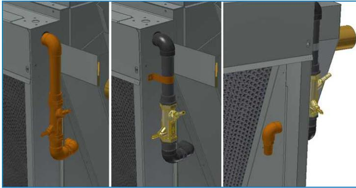
19. Fare scivolare il manicotto di gomma con le fascette sul drenaggio della canalina di raccolta acqua inferiore.
