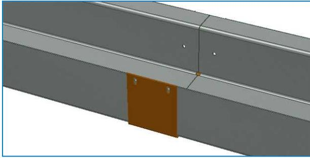
14. Installare la canalina di raccolta acqua inferiore sul telaio.
