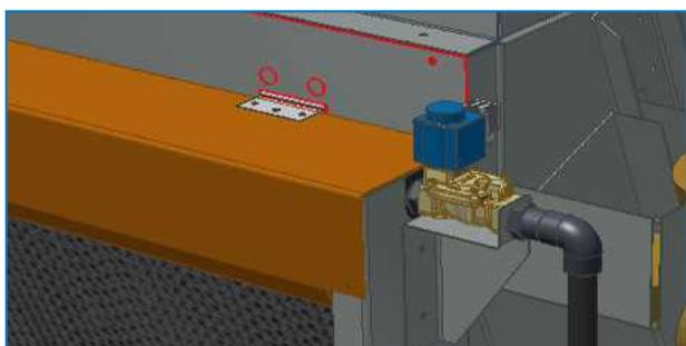
13. Se la canalina di raccolta acqua inferiore è composta da più parti, dovranno essere unite insieme con la fascetta e i rivetti dopo avere applicato sigillante liquido sulla fascetta.
