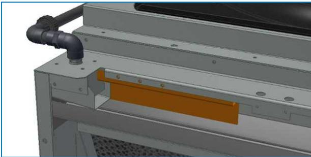
12. Installare il coperchio anteriore sulla vasca di reintegro e bloccarlo in posizione mediante viti nei fori adiacenti.
