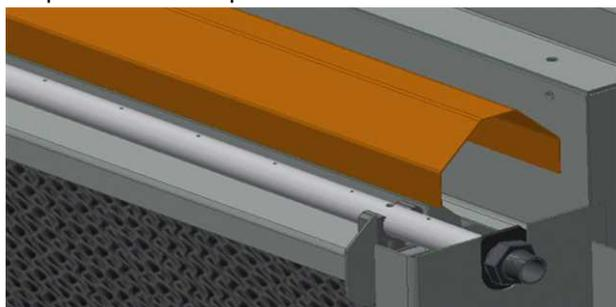
11. Nel caso di un coperchio superiore suddiviso (TVFC EC 8024, TVFC EC 8025, TVFC EC 8026 o TVFC EC 8027), installare 2 supporti sul deflettore centrale come illustrato di seguito.
