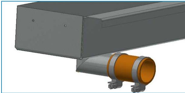
20. Se la canalina di raccolta acqua inferiore è composta da diverse parti, unirle insieme con la clip e i rivetti dopo avere applicato sigillante liquido sulla clip.
