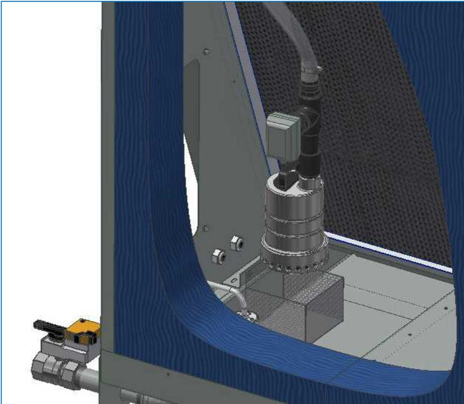
3. Retire los pernos que fija el filtro a la balsa para desmontarlo, así como para limpiarlo fuera de la unidad.
