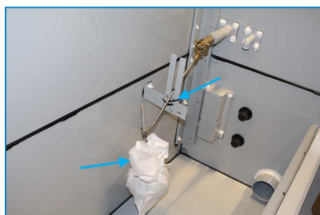
Fissaggio e avvolgimento della palla galleggiante
