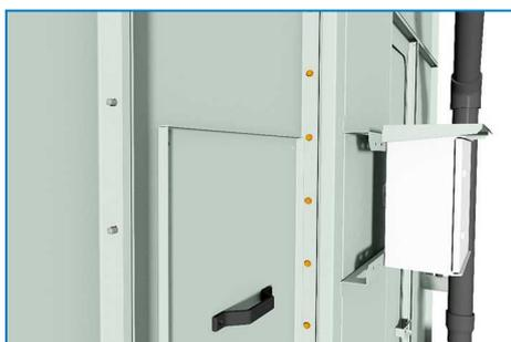
Sollevarre l'attenuatore in aspirazione in posizione. Assicurarsi che i fori di fissaggio dell'attenuatore in aspirazione siano allineati ai fori dell'unità. Fissare con tappi.
