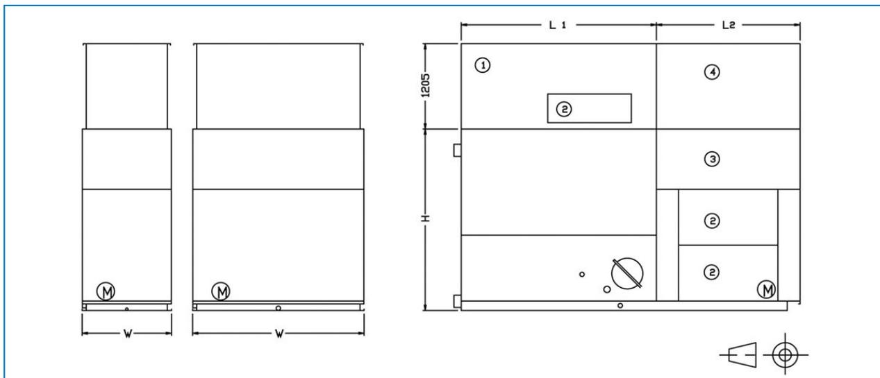
1. Attenuatore in scarico; 2. Portello d'ispezione; 3. Attenuatore in aspirazione; 4. Plenum; Alt e Larg: altezza e larghezza dell'unità (vedere dati tecnici).
