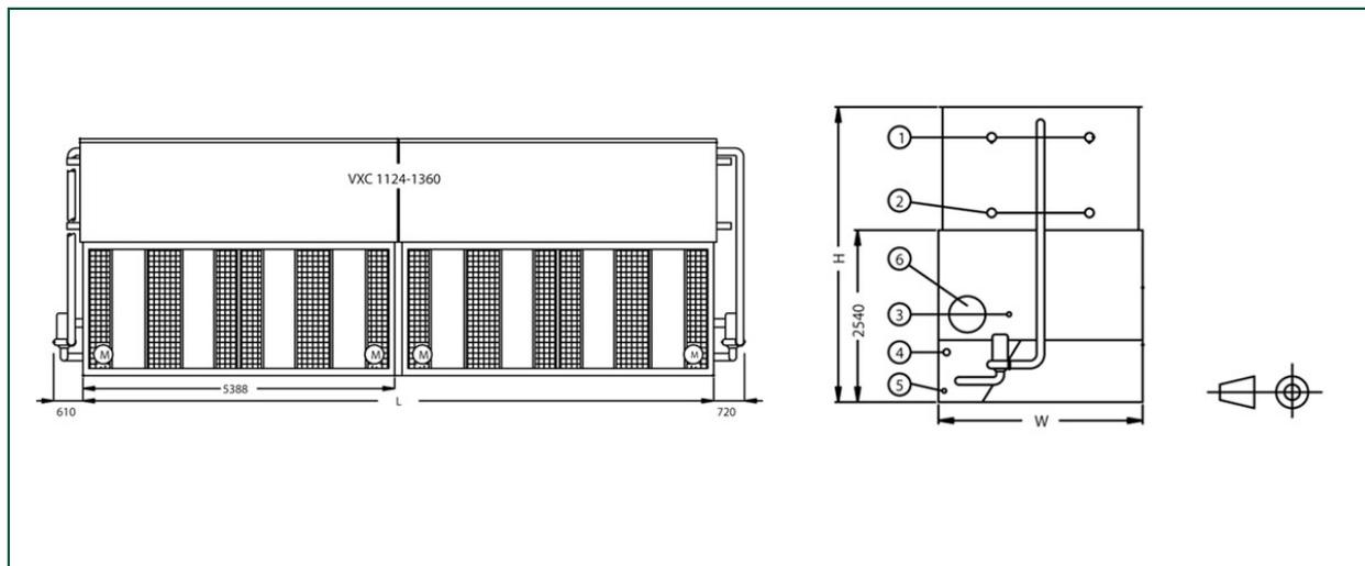
1. Entrada refrigerante ND100; 2. Salida refrigerante ND100; 3. Llenado; 4. Rebosadero ND80; 5. Vaciado ND50; 6. Acceso; para VXC 1124 a 1360: llenado ND80.
