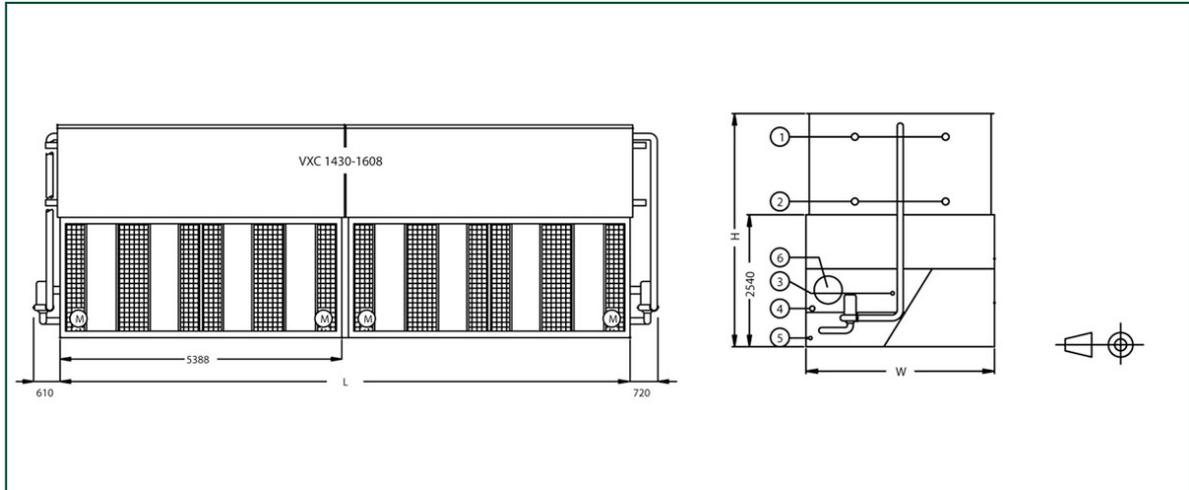
1. Entrada refrigerante ND100; 2. Salida refrigerante ND100; 3. Llenado; 4. Reosadero ND80; 5. Vaciado ND50; 6. Acceso. Para VXC 1430 a 1608: Llenado ND80. ND50.
