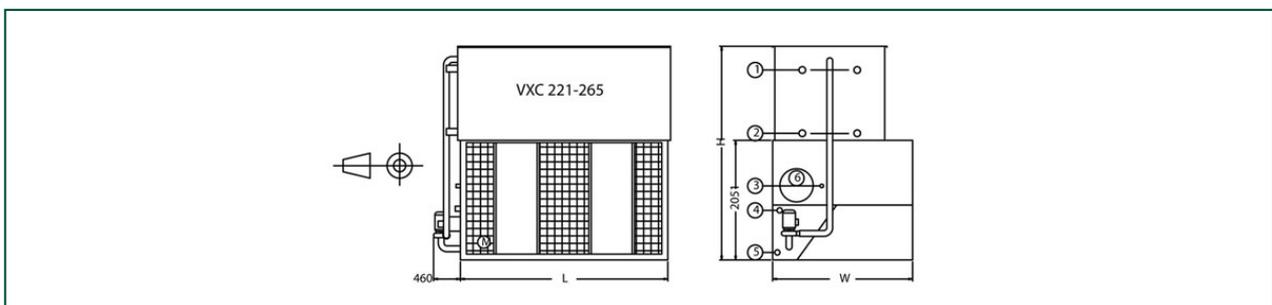
1. Entrada refrigerante ND100; 2. Salida refrigerante ND100; 3. Llenado; 4. Rebosadero; 5. Vaciado; 6. Acceso; para VXC 150 a 265; llenado ND50; rebosadero ND80, vaciado ND50.
