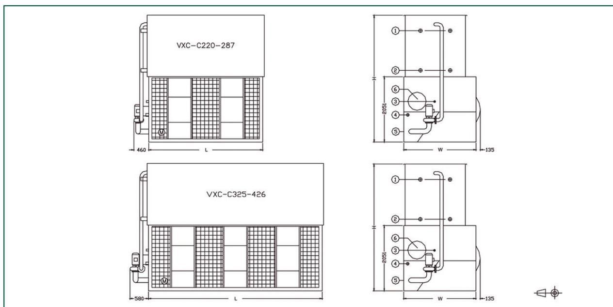
1. Entrada refrigerante ND100; 2. Salida refrigerante ND100; 3. Llenado ND50; 4. Rebosadero ND80; 5. Vaciado ND50; 6. Las tapas del ventilador se envían sueltas.
