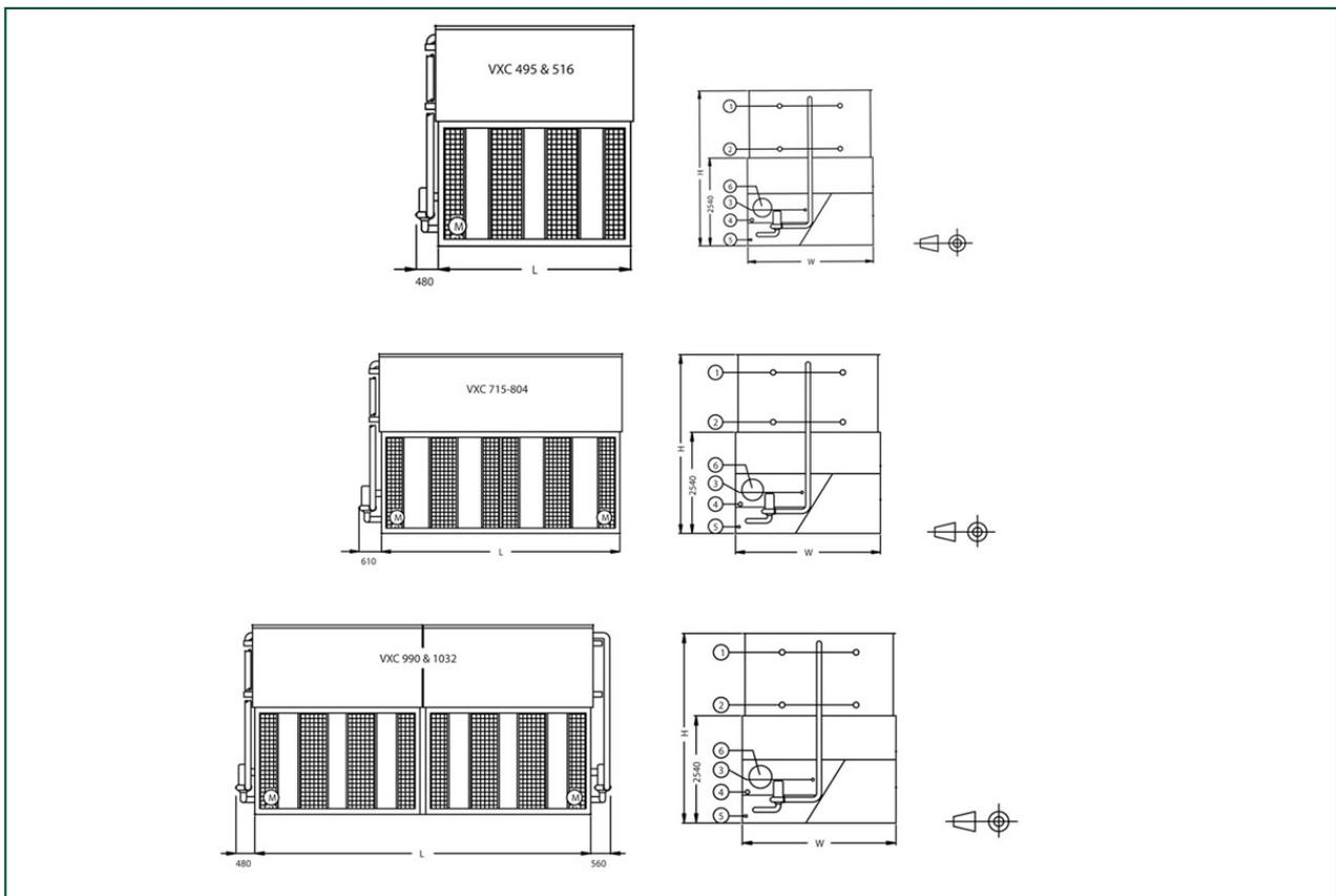
1. Entrada refrigerante ND100; 2. Salida refrigerante ND100; 3. Llenado; 4. Rebozadero ND80; 5. Vaciado ND50; 6. Acceso. Para VXC 495 a 1032: Llenado
