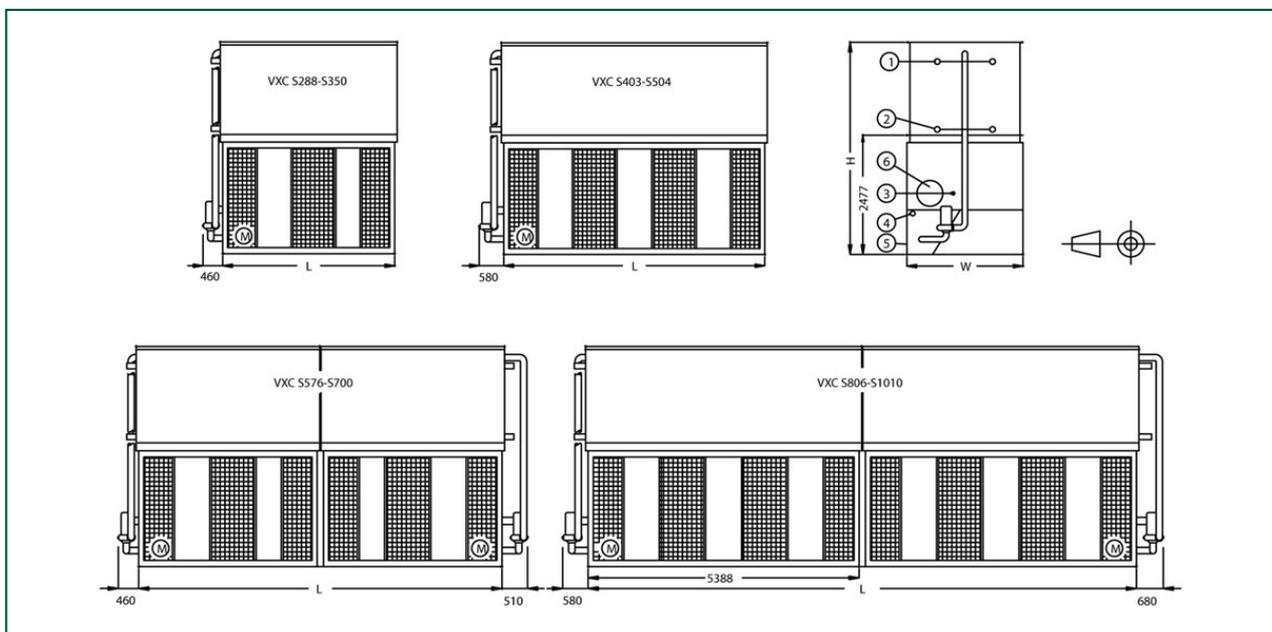
1. Entrada refrigerante ND100; 2. Salida refrigerante ND100; Llenado ND50; 4. Rebosadero ND80; 5. Vaciado ND50; 6. Acceso.
