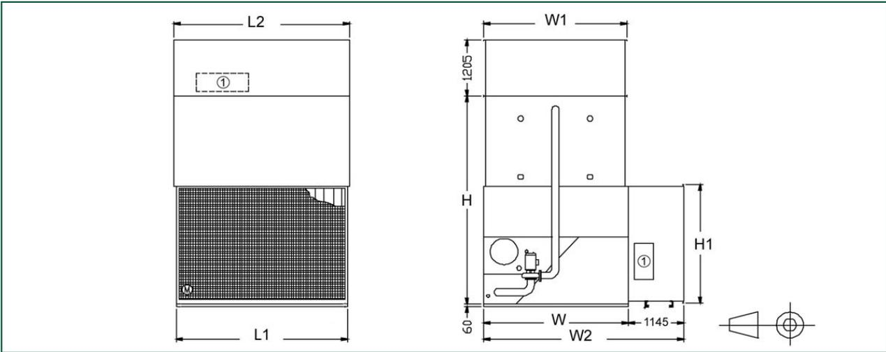
1. Puerta de acceso; L = Longitud del equipo; W = Anchura del equipo; H = Altura del equipo (ver Datos técnicos).
